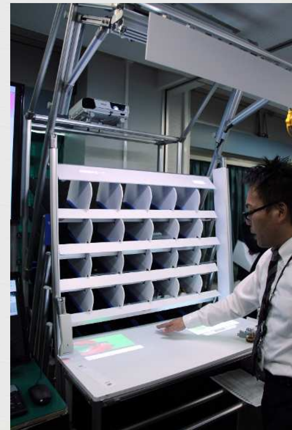
工場のピッキングシステム
